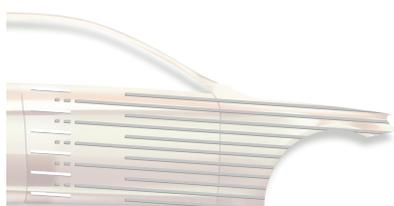
Applicare la prima mano del colore perlato Standoblue sul bordo di Standoblue Color Blend 8570 / Standoblue Color Blend Slow 8580 ancora bagnato. Lavorando dall'esterno verso l'interno dell'area più ampia, è necessario applicare ulteriori mani all'interno dello strato precedente per completare la riparazione e ottenere il punto tinta. Tutta l'applicazione è con processo bagnato su bagnato. Appassimento ed essiccazione come indicato nella pagina precedente.
